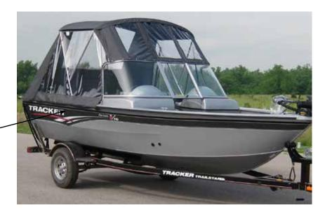
SNAPS FOR THE SIDE CURTAINS INSTALL UNDERNEATH THE GUNNEL.
